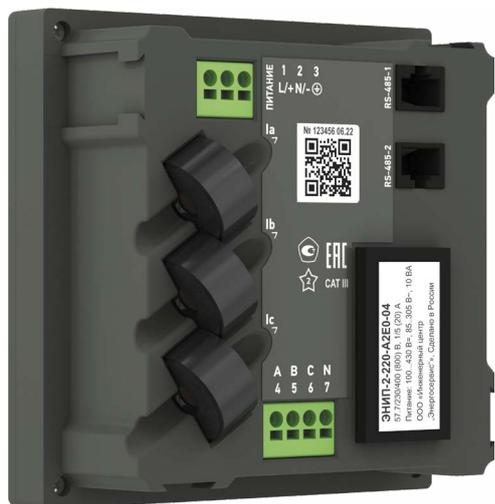
В отличие от других версий серии ЭНИП-2 данная модификация имеет универсальные измерительные входы, к которым можно подключать токовые цепи с номинальными значениями 1 А и 5 А, цепи напряжения с номинальными значениями 57.7 В, 230 В и 400 В (фазные). Таким образом, при заказе ЭНИП-2 Панель не требуется выбирать значения номиналов входных сигналов.
